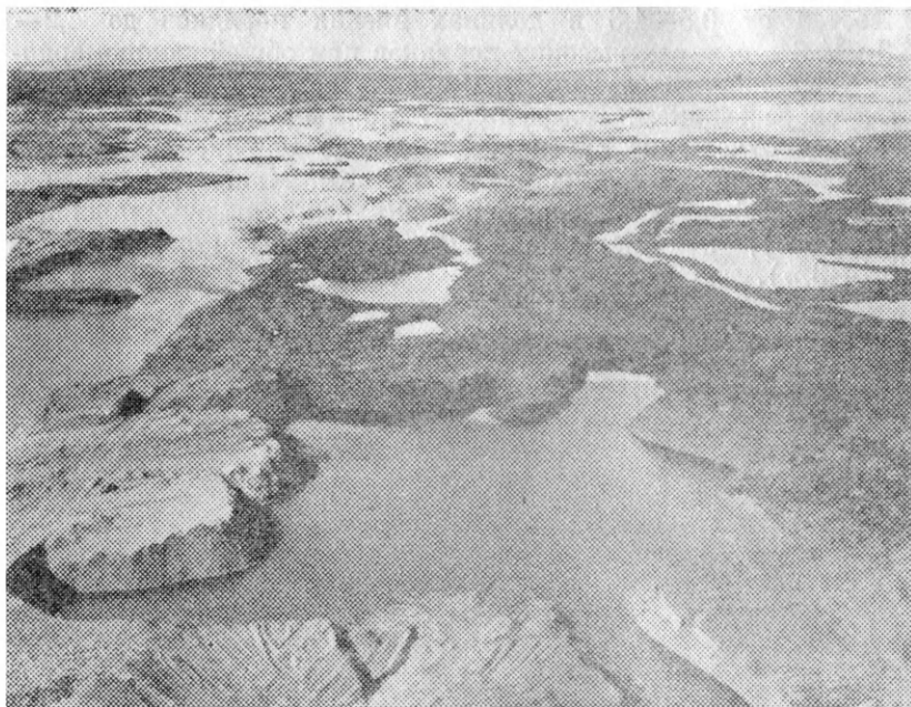
Рис. 3.4. Техногенный комплекс открытой разработки россыпи — автомобильные и бульдозерные отвалы вскрышных пород, котлованы
